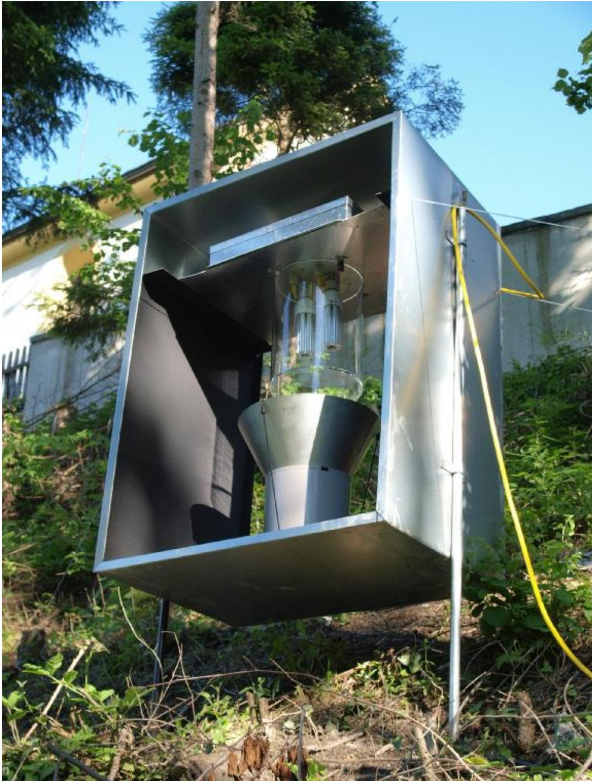
Abb. 1: Lichtfallenkonstruktion
