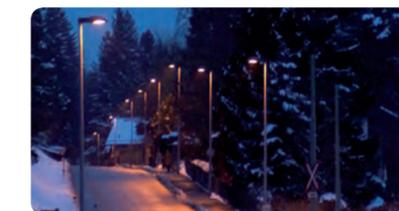
**Reduktion der Beleuchtungsintensität von Straßenbeleuchtungsanlagen** in verkehrsschwachen Zeiten (etwa zwischen 23 und 5 Uhr) mittels Halbnachtschaltung oder Reduzierschaltung. So kann die Beleuchtungsintensität dem Bedarf angepasst werden (Nachtabenkung).
